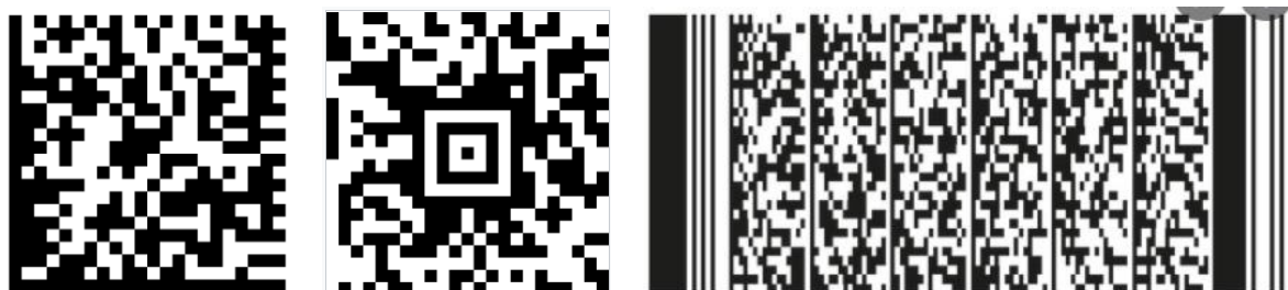
9. ábra QR kódokhoz hasonló 2D kódok: DataMatrix, Aztec, PDF417
