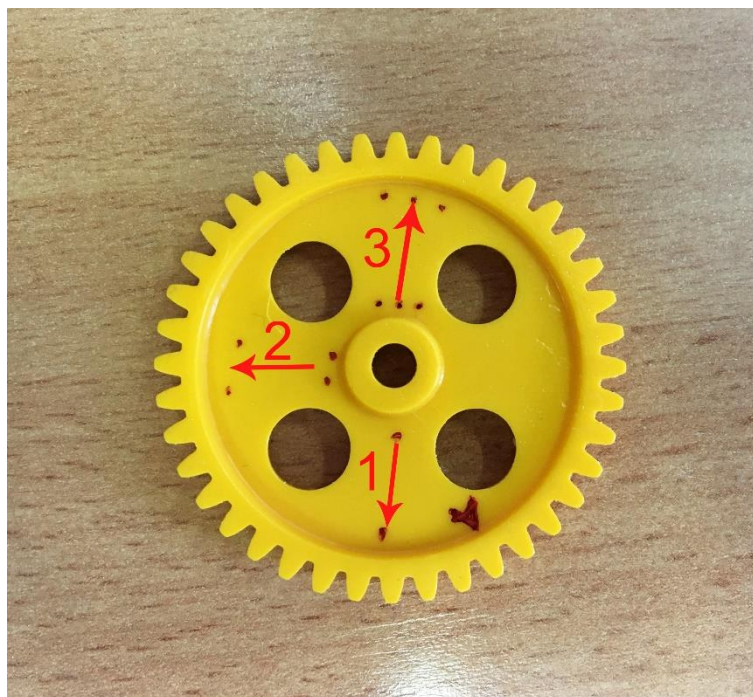
4. ábra Kisebb méretű fogaskerék felületi érdesség mérési pontjai és a mérések irányai
