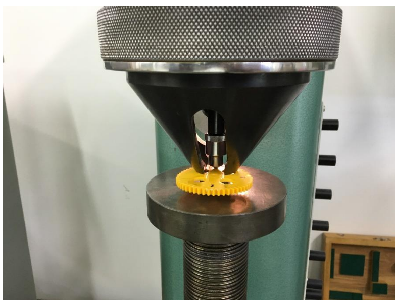
9. ábra Golyóbenyomódási keménység mérése 5mm-es acélgolyóval és 30 Kp-os terhelőerővel
