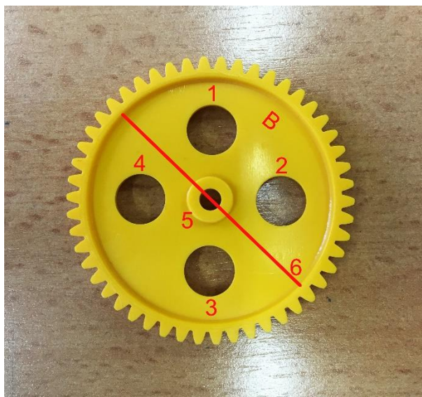
7. ábra A nagyobb átmérőjű fogaskerék geometriai méréseinek pontjai
