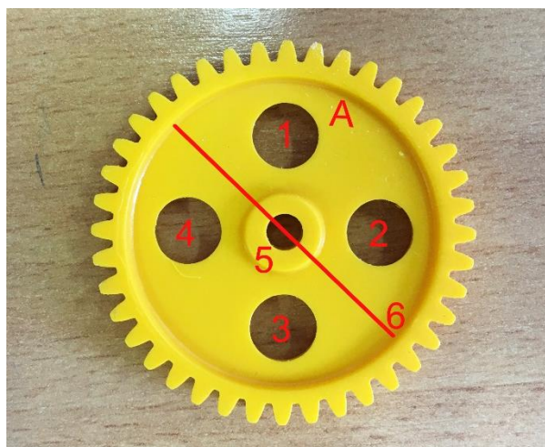
8. ábra Kis átmérőjű fröccsöntött fogaskerék geometria mérési pontjai
