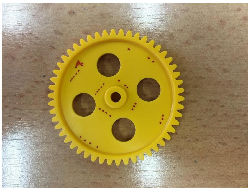
3. ábra Felületi érdesség mérési pontjai a nagyobb átmérőjű fogaskeréken
