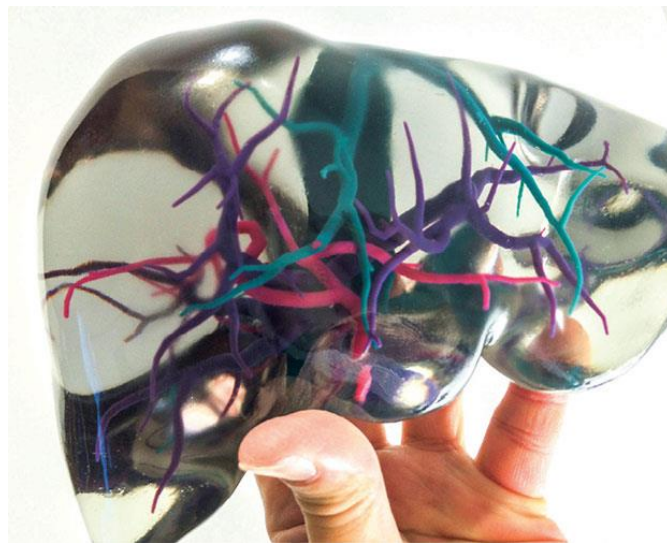
6. ábra Kombinált anyagok nyomtatása Polyjet technológiával
