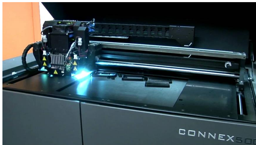
2. ábra Polyjet nyomtató munka közben
